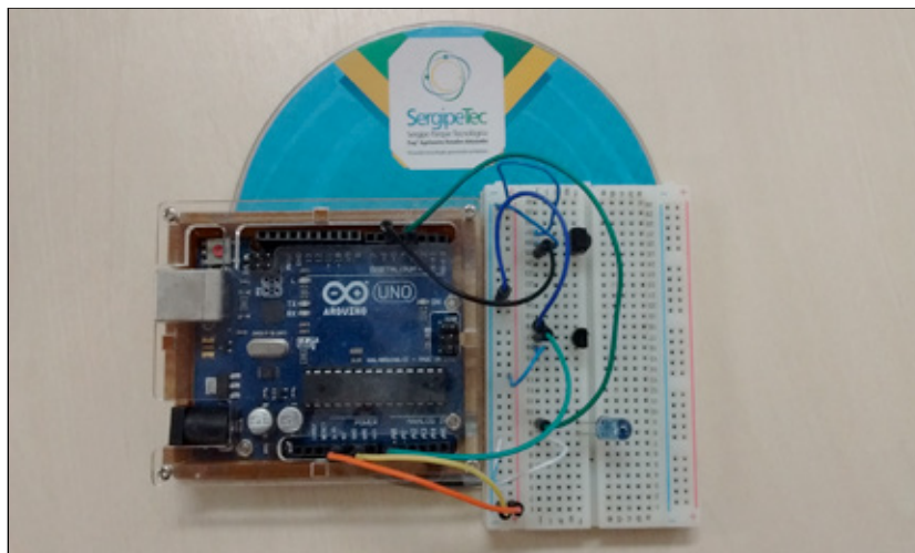
Figura 1: Projeto com microcontrolador para controle de ar condicionado. Fonte: SERGIPETEC (2017).
